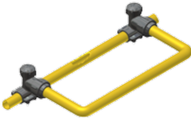
4. Install PE pipe by-pass
