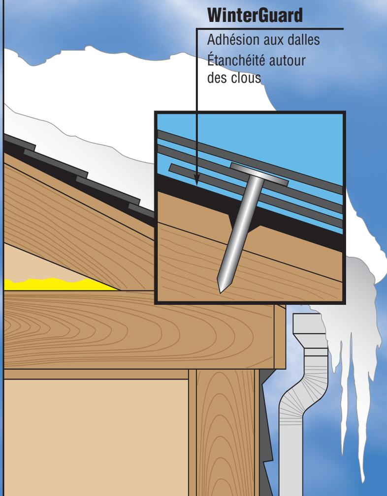
Les sous-couches étanches pour bardeaux de la série WinterGuard™ sont appliquées sous les bardeaux de toiture pendant une construction nouvelle ou la réfection d'une toiture, afin de protéger l'intérieur de votre maison contre les fuites en hiver, qui sont causées par des digues de glace et des pluies poussées par le vent.
