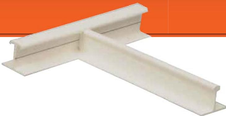
Sanigríd II é um sistema de grades para painéis de teto em fibra de vidro que resiste a umidade em ambientes de alta umidade e concentração de químicos. Não é suscetível a corrosão, marcas, amassados ou descascamento como nos sistemas metálicos e é fácil de instalar.
