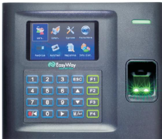
CronoStation es una solución versátil e innovadora para control de asistencias y accesos que combina una estructura robusta y un diseño elegante con una amplia variedad de métodos de identificación, desde código de barras, hasta huella y proximidad 125 kHz, Mifare o HID iClass.
