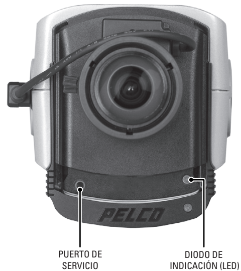
VISTA FRONTAL, CÁMARA ÚNICAMENTE (ABIERTA PARA EXPONER EL PUERTO DE SERVICIO)
