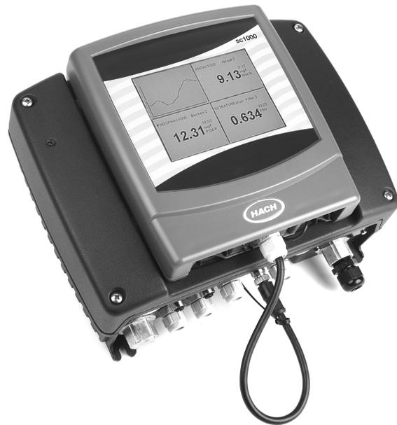
*El modelo de controlador universal multiparámetro sc1000 de Hach es un sistema controlador modular de última tecnología. Úselo directamente con 8 sensores o conecte varios en red para disponer de más sensores y parámetros. Es totalmente compatible con toda la gama de sensores digitales de Hach.*
