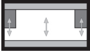
4 Way ScreenWall ElectriMask Allows 1.33:1, 1.78:1, 1.85:1, 2.0:1, 2.35:1
