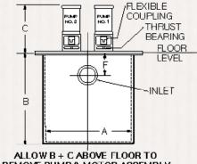
REMOVE PUMP & MOTOR ASSEMBLY
