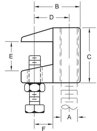
**FIGURE 192 – TOP BEAM CLAMP**
